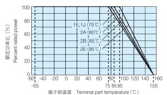
超过上述端子部温度使用时,请根据负荷减轻特性曲线减小额定功率后使用。 ※ 有关使用方法,请参照卷首的"端子部温度负荷减轻特性曲线的说明"。
