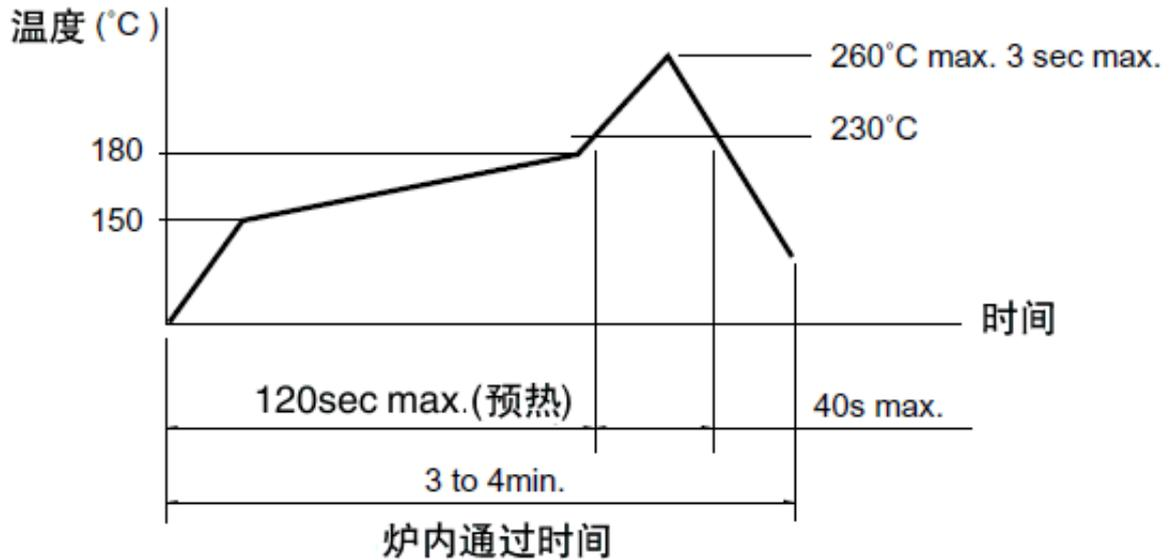
(1) 上述条件,为印刷电路板的零部件表面的温度。根据电路板的材质,大小,厚度等,电路板温度和开关表面温度会有很大的不同,关于开关表面温度,也请在上述条件内使用。
